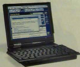
Блокнот IBM ThinkPad 701C поставляется с 10,4-дюймовым экраном на активной или пассивной матрице и имеет уникальную клавиатуру, которая раскладывается, когда вы открываете ПК.
