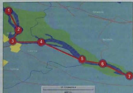
Рис. 4. Фрагмент Цифровой карты мира: русло Волги недалеко от Нижнего Новгорода. Река и ее притоки закрашены синим цветом. Тонкие красные линии и красные линии с поперечниками — шоссе и железные дороги. Желтые многоугольники — населенные пункты, зеленые области — заливные луга. Красные кружки и ломаная красная линия — вариант векторного представления данного участка русла реки как линейного объекта.
