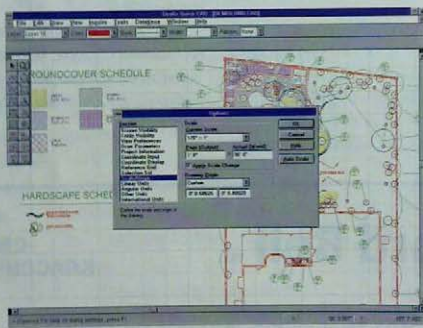
В диалоговом окне Options, открываемом из меню Tools программы QuickCAD, можно произвести установку текущих параметров.
