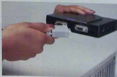
3 Освобожденный конец кабеля соедините с разъемом VGA Out конвертера.
