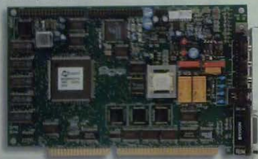
Звуковые платы для телефонии превращают компьютер в автоответчик, поддерживающий до 1000 речевых почтовых ящиков.
