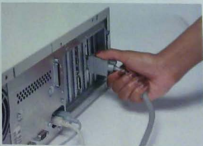
2 Найдите видеокабель, соединяющий системный блок компьютера с монитором, и отключите его от системного блока.
