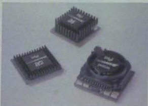
Процессор Pentium OverDrive предоставляет относительно недорогой способ в 2-3 раза повысить скорость 486-й системы.
